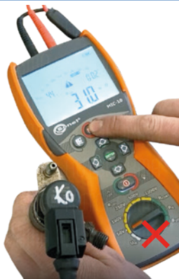
Element piezoelektryczny po zwarciu
